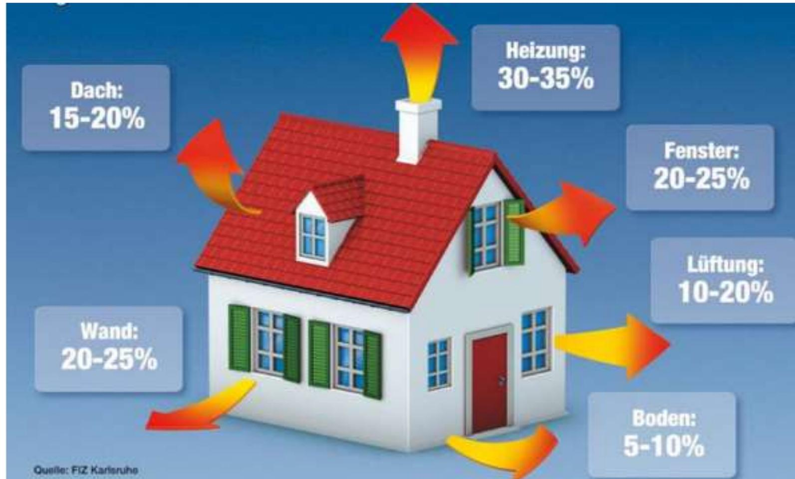
Abbildung 6: Wärmeverluste im Einfamilienhaus mit einem Baujahr vor 1995, Quelle: baulinks.de
