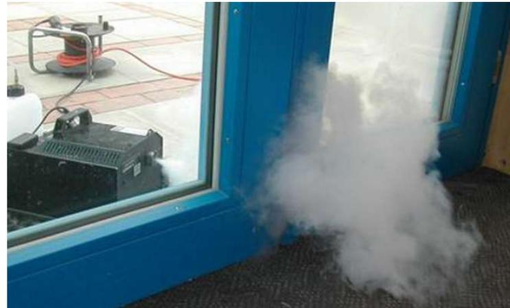
Beispiel: eine Leckage von  $595\text{m}^3/\text{h}$  entspricht unter Standardbedingungen einer kreisrunden Öffnung von ca. 20 cm
